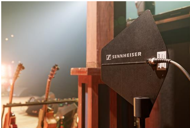
Als Antennen finden zwei passive Sennheiser A 2003-UHF Richtantennen Verwendung
